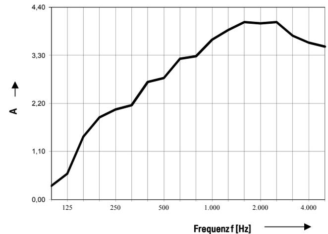
$\alpha_p$  / Frequenz [Hz] nach DIN EN ISO 11654
