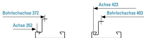
Beispiel für Einmessung der Bohrlöcher für die Montage eines Deckensegels BALANCE POLAR im Format: < 2.250 mm mittels Seilabhänger.
