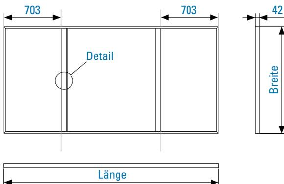
pinta BALANCE POLAR Deckensegel mit einer Länge  $\geq 2800$  mm sind in der Mitte mit einem zusätzlichen Montageprofil ausgestattet, dies dient der Produktstabilität. Zur Abhängung sind die beiden außenseitigen Montageprofile zu verwenden.
