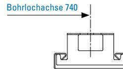
Detail: Abhängung Z-Profil (gleichgerichtet)
